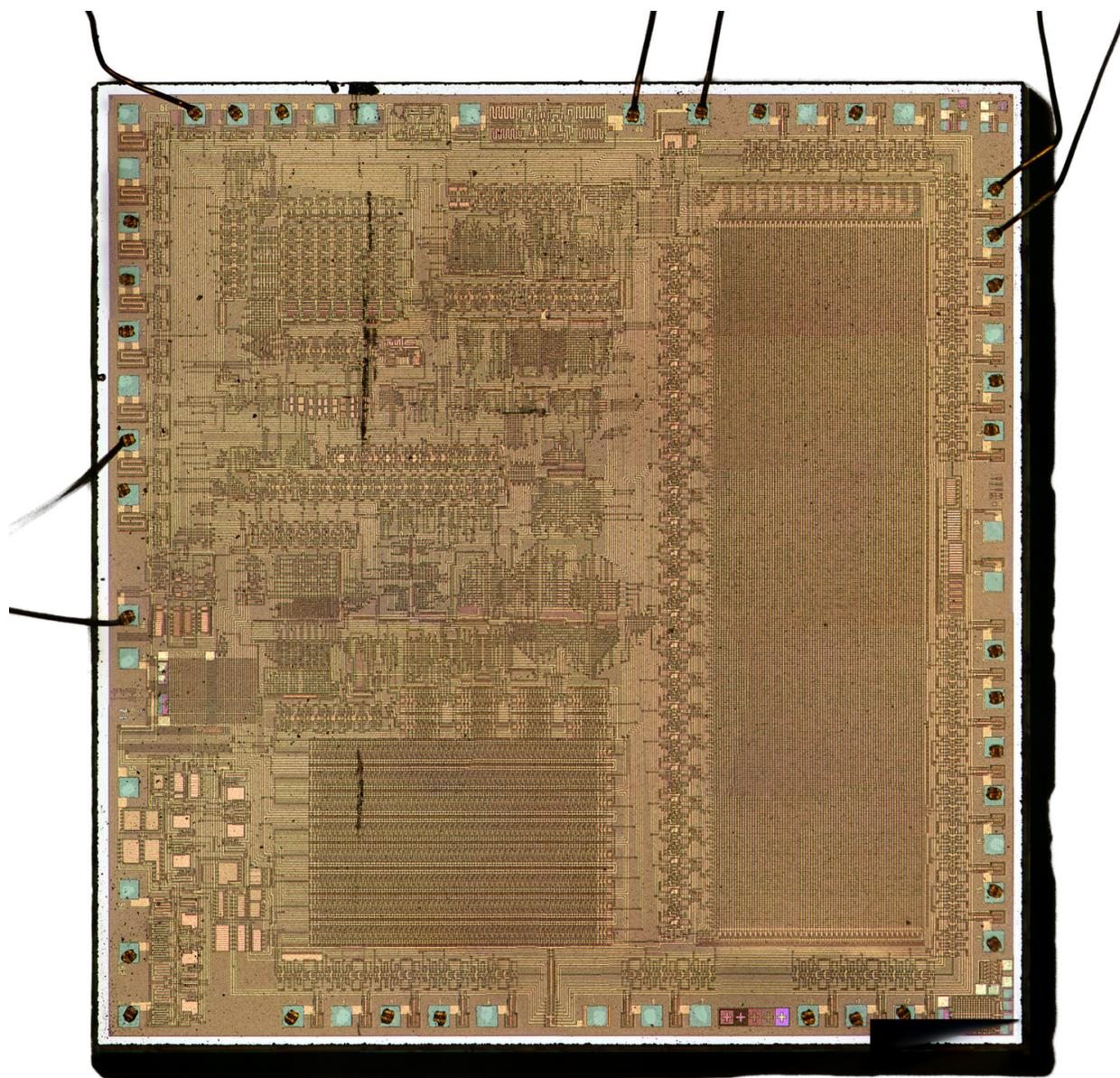
Figure 7: K757ИП1-2 from an Электроника МК-51, Top Metal
