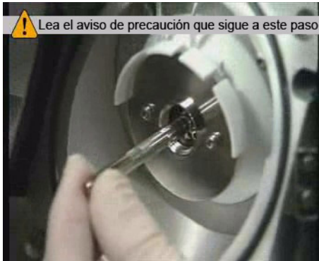
Figura 37 Cómo tirar del capilar para sacarlo del dispositivo de eliminación de disolvente
