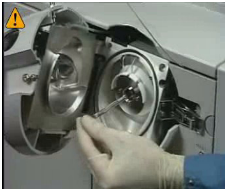
Figura 38 Colocación en su sitio del capilar
