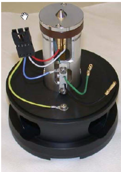
Figura 62 El conjunto de óptica de iones montado de nuevo
