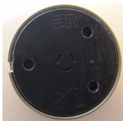
Figura 48 Válvula del rotor del CDS en la orientación correcta
