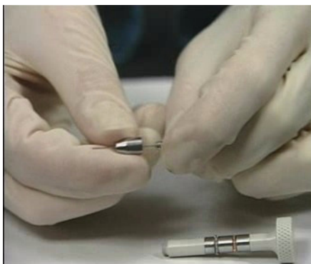
Figura 35 Colocación de una nueva aguja en el collarín
