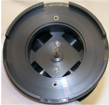
Figura 54 Barras del octopolo sobresaliendo por el espaciador del divisor
