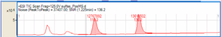
图 12 具有“面积”和“信噪比”标签的积分 TIC
