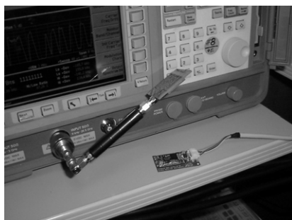
図16 Agilent ESA-Eスペクトラム・アナライザにRangeStar Bluetoothアンテナを装備してBluetooth信号を無線で受信しているところ
