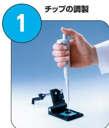
溶液状のゲル(電気泳動の場合)、バッファ、サンプルをチップに載せます。
