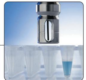
リキッドコンタクトコントロールで、針先端部と液面との間の連続的な接触を実現しています。そのため、フラクションがよりシャープに、また、再現性が最高のフラクション容量が得られます。さらに、フラクション収集プロセスでの小さな円錐ウェル内の気泡の発生や、さらにフラクションの二次汚染を防げます。
