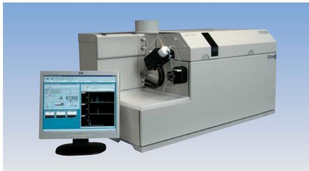
ICP-MSは、金属を中心とした元素を高速かつ高感度に測定する装置です。各種研究や半導体関連試薬類中の超微量不純物の分析から、河川水や水道水、廃水などの環境分析まで、幅広い分野で使用されています。Agilent 7500シリーズでは、スタンダードモデルの7500aをはじめ、それぞれの分析目的にあわせて有効な、シールドトーチシステムやオクタポールリアクションシステム(ORS)を搭載した各種モデルをラインアップ。購入後のアップグレードやコンバージョンにも対応するなど、アプリケーションの変化に合わせた柔軟な選択も可能です。
