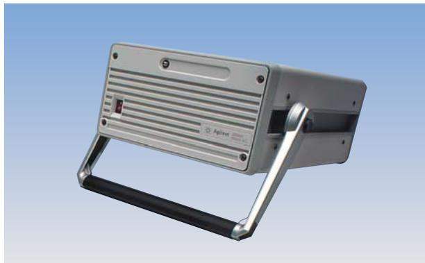
作業現場とラボのニーズを同時に満たす、小型かつ簡単操作のガス分析用高速ガスクロマトグラフです。
