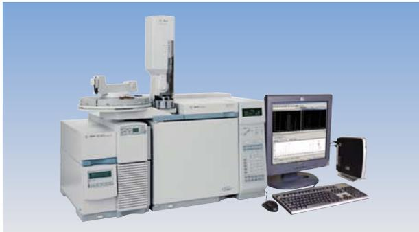
飲料水中および食品中の農薬分析や環境ホルモンの分析など、液-液抽出や固相抽出された液体サンプルを注入する場合に用いられます。EPCを用いたパルスドスプリットレスや、PTV(プログラムブル温度気化)注入などの注入法を用いれば大容量のサンプルを正確に再現性良く導入でき、高感度分析が可能になります。塩素系農薬のように負イオン検出が可能なサンプルであれば、負イオンモードでの化学イオン化法を用いて、さらに感度アップを図ることができます。
