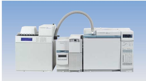
ヘッドスペースサンプリングを用いた分析では、サンプルをバイアルに詰めるだけであとの処理が全く必要ありません。前処理から分析-データ処理までを完全に連続自動運転(オートサンプリング最大44サンプルまで)することができます。また、装置が非常にシンプルでトラブルも少なく、稼働率も高いというメリットがあります。
