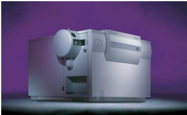
マルチポールタイプのイオントラップ型LC/MS<sup>n</sup>です。ノンリニアスキャンによりこれまでにない高速スキャンと分解能を実現しました。微量化合物の定性や定量分析に大きな威力を発揮します。
