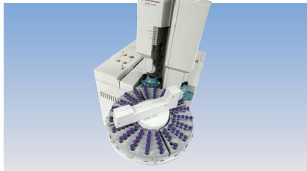
優れた注入再現性を実現し、サンプルディスクリミネーションを最小にした高速注入(0.1秒)が可能な、Agilent 6890Plus/6850GC用のオートサンプリングシステムです。
