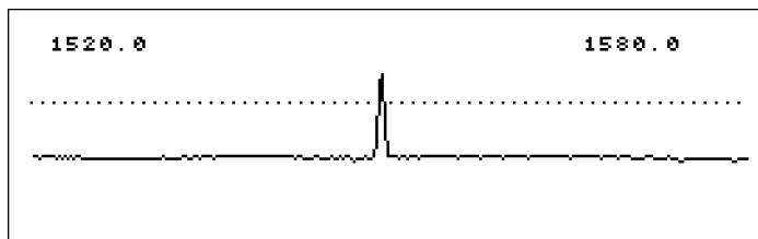
PRBS 変調によるノイズ・フロアの上昇
