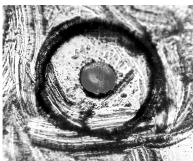
図1-6. 不適切な清掃に起因する損傷
