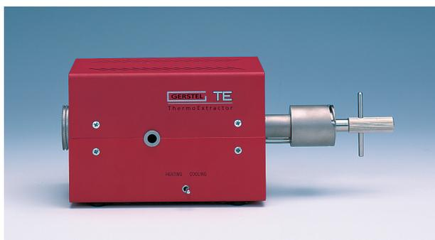
TE 2は外径16mmの大型チューブが収納される加熱炉を持っています。サンプルから加熱脱着された成分は加熱炉の外側に取り付けられたTDSチューブへと移送され吸着剤に捕集されます。この時、Tenax TAなどの疎水性の吸着剤を選択する事により水分の多いサンプルも水の影響を最小限に抑え、分析することが可能です。
