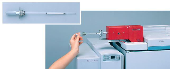
▲試料チューブを取り付けたマウンティングエレメント(写真上)マウンティングエレメントをTDS 2に挿入(写真下)
