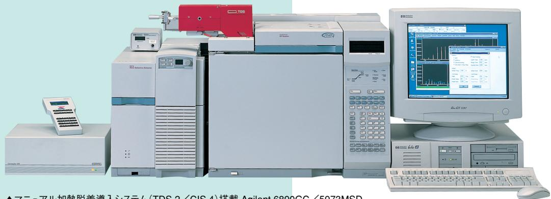
▲マニュアル加熱脱着導入システム(TDS 2/CIS 4)搭載 Agilent 6890GC/5973MSD
