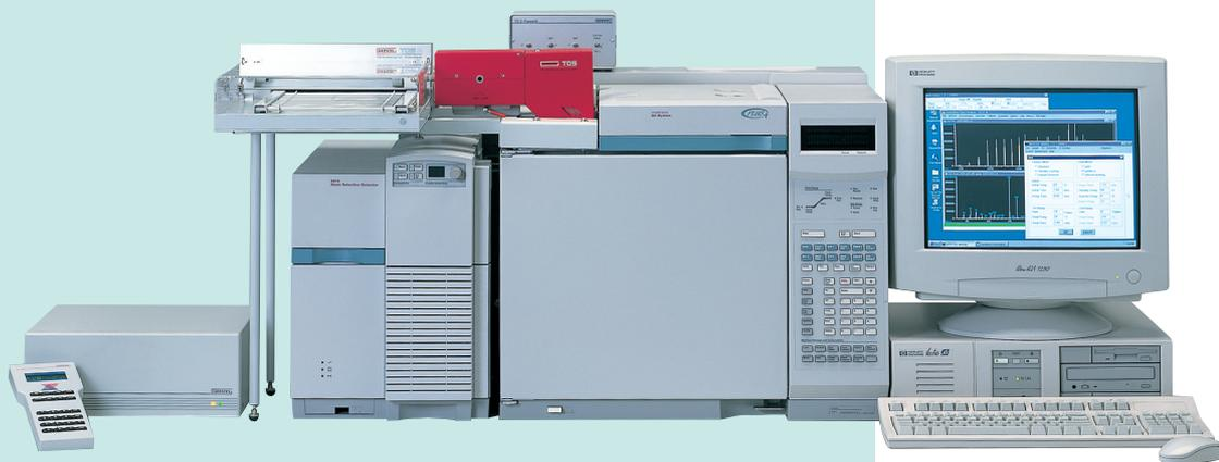
▲20検体オートサンプラー付加熱脱着導入システム(TDS A/TDS 2/CIS 4)搭載 Agilent 6890GC/5973MSD
