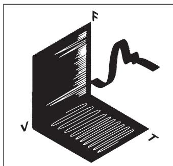
タイミング測定の場合、モジュレーション・ドメインではタイミング・ジッタを直接観測し、定量化することができるため、タイム・ドメインにおける定性的観測よりも一歩進んだ解析が行えます。
