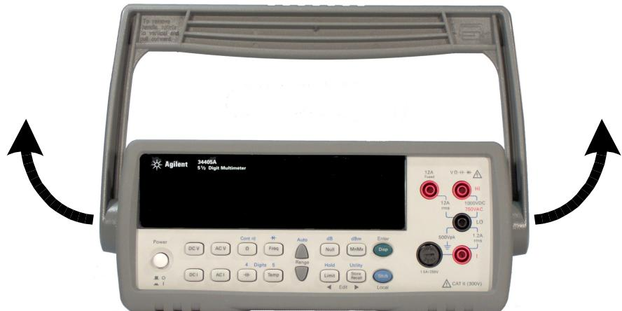
3 移除儀器緩衝器。從角落的方向用力拉並將緩衝器從儀器上用力拆下。
