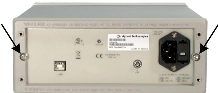
**5** 移除外蓋。移除外蓋底部的螺絲，即可將外蓋以滑動方式從儀器上取下。
