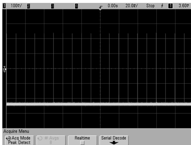
图 44 15 ns 窄脉冲，20 ms/div，Peak Detect 模式
