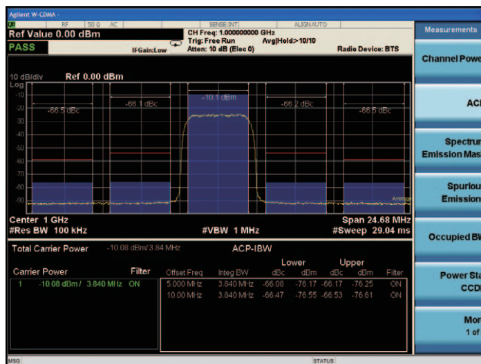
図6-9. PXA スペクトラム・アナライザによる隣接チャネル電力測定
