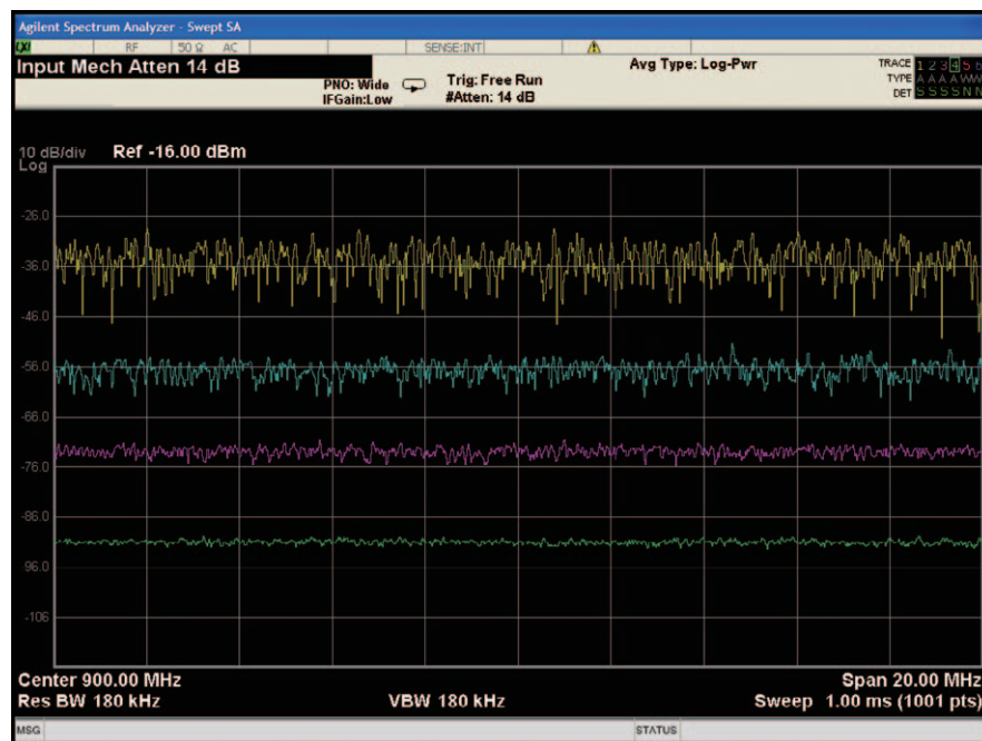
図2-31. トレース平均処理の例。掃引回数は画面の上から順に1、5、20、100回(アベレージ回数ごとに縦軸をずらして表示しています)
