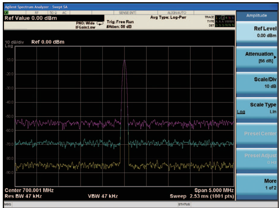
図5-1. 現代のシグナル・アナライザでは、入力アッテネータでの減衰量を変更しても信号レベルは変わりません
