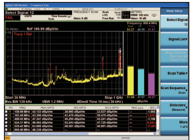
図1-6. EMI試験の1つであるCISPR11上限値に対する放射エミッションの測定例
