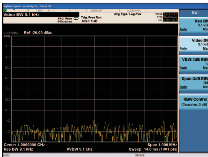
図2-27. スペクトラム・アナライザは信号とともにノイズも表示します
