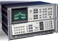
Agilent 8566Bターボ ディスプレイで24回/s、 GPIOで15回/sのアップデート
