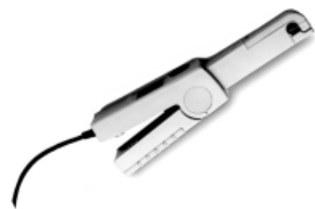
图5.3.Agilent 1146A 100 mA 至100 Arms, dc 至 100 kHz 探头
