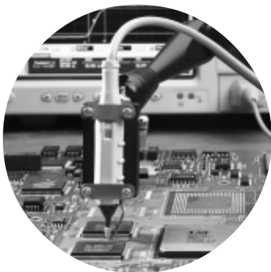
图 3.2. Agilent 1156A/57A/58A 有源探头，可探测高达 4GHz 的信号
