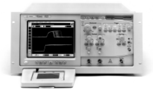
图14.1.Infiniium示波器已准备好装入EIA标准 19 英寸机柜
