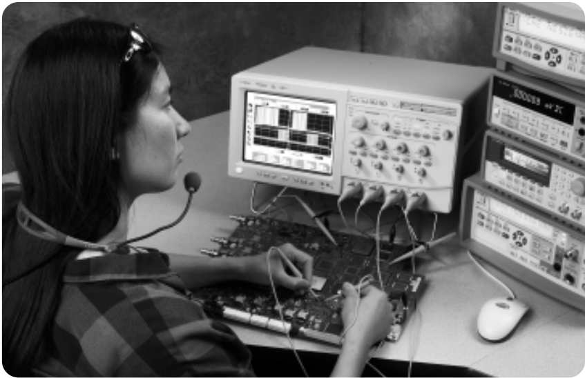
图 9.1.语音控制使您能脱手控制示波器。
