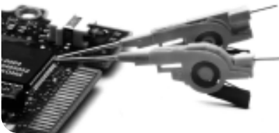
图 7.2.适用于探测 PQFP 和 SOIC SMT 封装的极小 IC 夹
