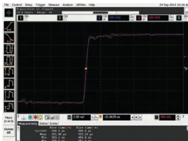
N2796A 的时域阶跃响应 (使用 Agilent MS09404A)
