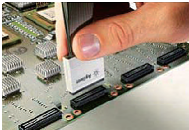
E5385A 34 通道 Samtec 连接器探头
