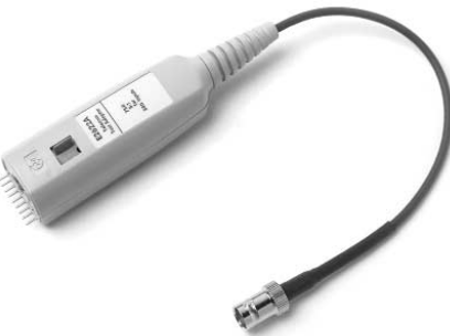
図13.3 E2622A DC結合不平衡アダプタを使用すれば、DS3やE3などの通信信号をオシロスコープの50ΩBNC入力に接続することができます。
