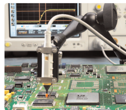
図3.13 Agilent E2654A EZ-Probe ボジショナ・オプションを使用すれば、プローブの安定かつ正確なX、Y、Z位置決めが可能です(本書の「プロービング・アクセサリ」の「EZ-Probeボジショナ」を参照してください)。
