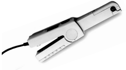
図5.3 Agilent 1146A 100mA～100Arms、DC～100kHzプローブ
