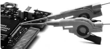
図9.2 PQFPおよびSOIC SMTパッケージ・プローピング用の超小型クリップ
