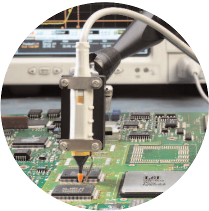
図3.2 最大で4GHzの信号用の Agilent 1156A/57A/58A アクティブ・プローブ
