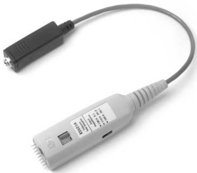
図13.2 E2621A AC結合平衡アダプタは、差動通信信号を100、110、120Ωで終端し、差動信号との接続を可能にします。
