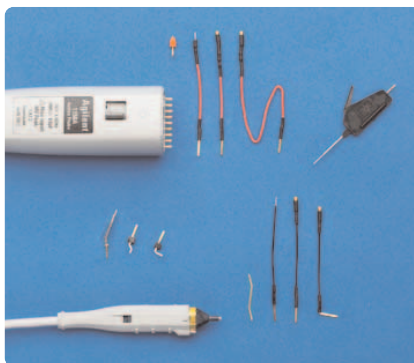
図3.9 高速信号用Agilent 1156A/57A/58Aアクティブ・プローブ
