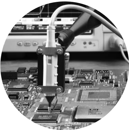
圖3.2：Agilent 1156A/57A/58A 主動式測試棒可量測高達 4GHz 的信號。
