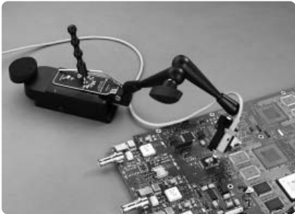
圖7.4：全關節式的機械手臂可在各種應用狀況下，提供精確的定位。
