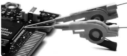
圖7.2：尺寸極小的 IC 夾可探量 PQFP 和 SOIC SMT 封裝 IC。
