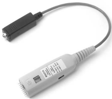
圖11.2：Agilent E2621A 交流耦合的平衡式轉接器可透過將信號終端到 100、110 或 120 Ω 負載上的方式，與差動通訊信號連接。
