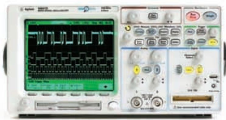
Figure 6. Facilitez vos tests industriels et automobiles. Le déclenchement réseau CAN se synchronise au départ d'une trame CAN sur n'importe quel signal CAN haut ou bas.
