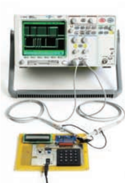
Figure 8. Déclenchement sur des modèles d'adresse et/ou de données dans une trame I 2 C.
