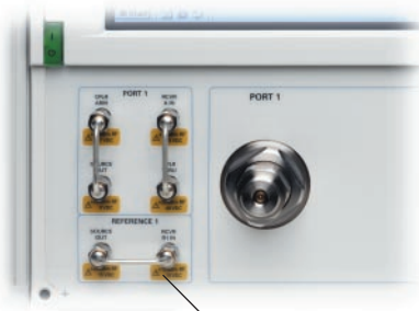
可配置的测试装置，信号接入路径可进行灵活配置
