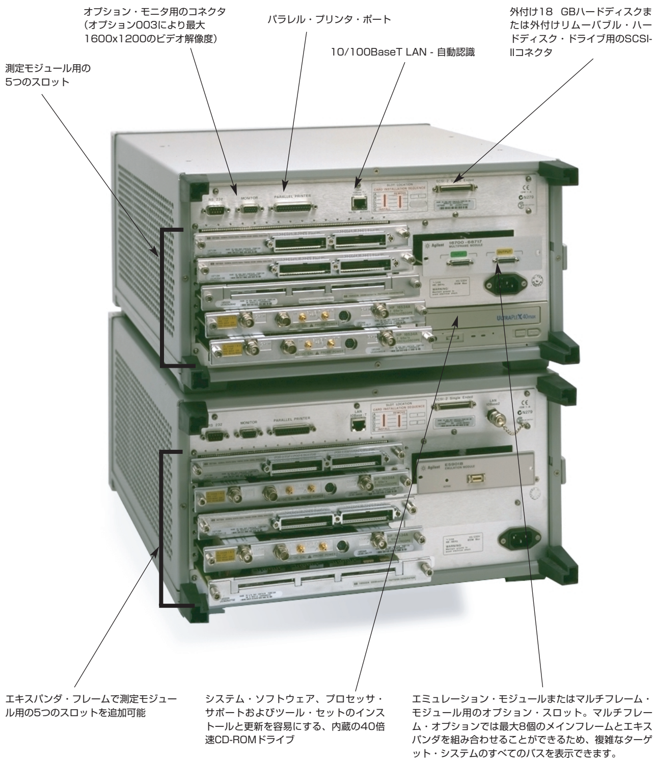
図 2.2. メインフレームとエクスパンダ・フレームは、複雑なターゲット・システムをデバッグするための優れた機能を提供します。
