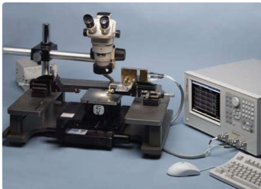
图 16. 安捷伦 E4991A 和探针台连用
