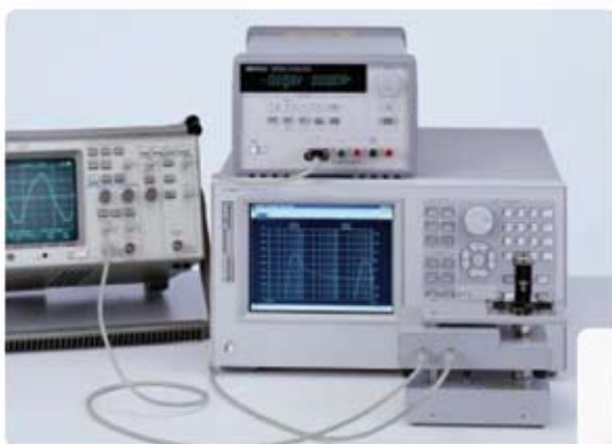
图 5. 使用 16200B 直流偏置适配器扩展 E4991A 的直流偏置范围
