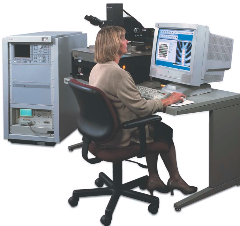
ラックに組み込まれた I-V / C-V 測定システム例
