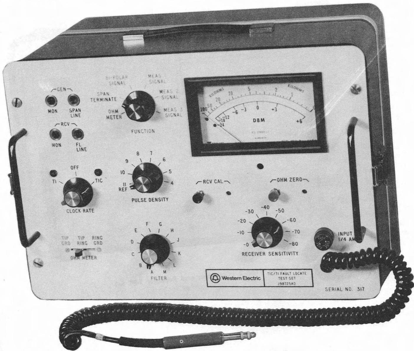
Fig. 4—J98725AD TIC/T1 Fault-Locate Test Set
