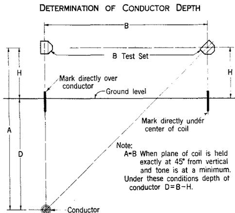
**Fig. 10—Determining Conductor Depth**
