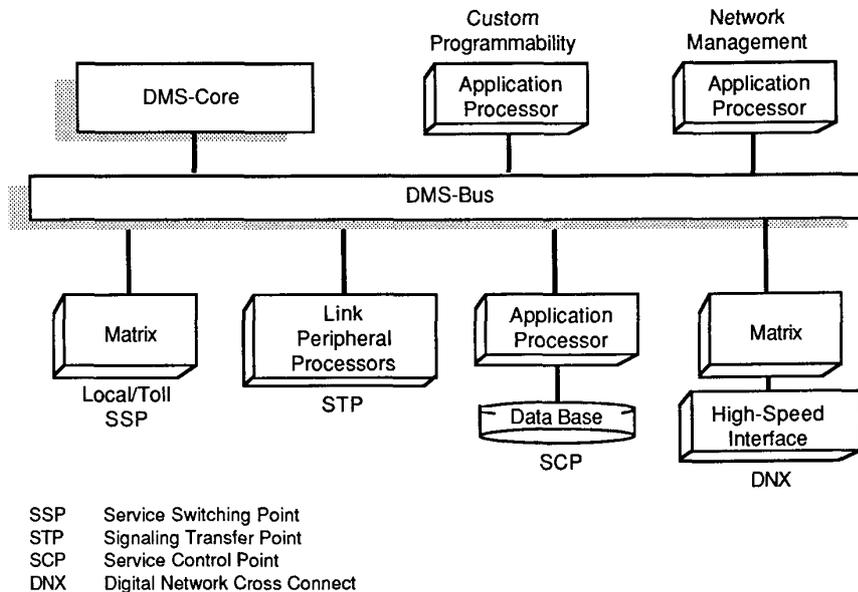
Figure 1. DMS SuperNode Multifunctional Architecture
