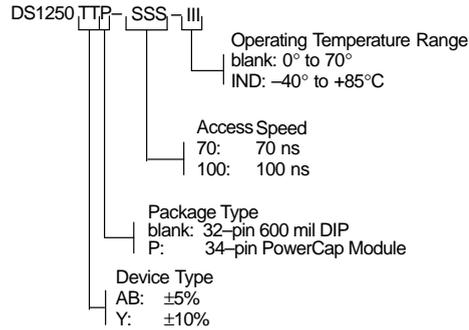
**DS1250Y/AB NONVOLATILE SRAM 32-PIN 740 MIL EXTENDED DIP MODULE**
