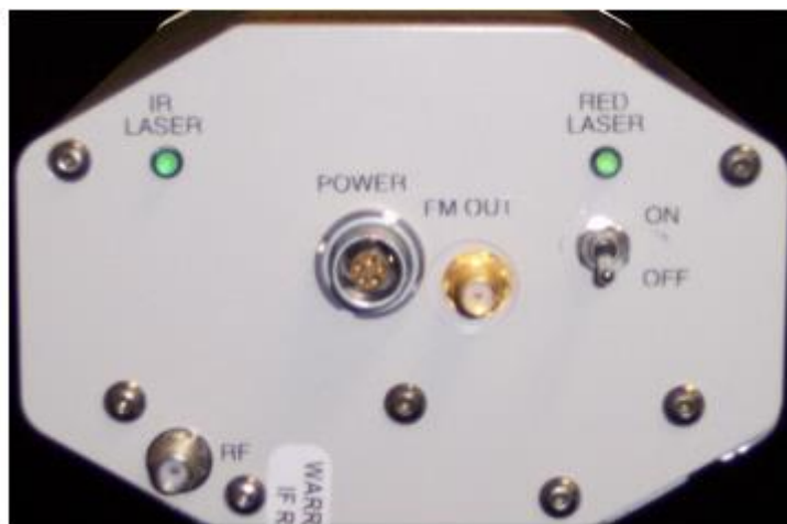
Рисунок 6 – Задняя панель измерительной головки VibroMet™ 500V.
