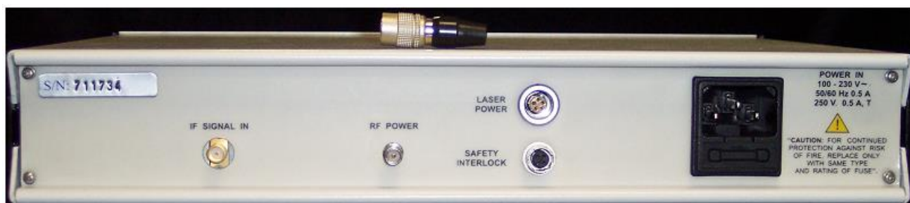
Рисунок 5 – Задняя панель контроллера VibroMet™ 500V с проводами. Предохранительная блокировка показана выше и подключается к контактному гнезду под сигнальным кабелем.
