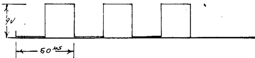
INVERTER STAGE - THIS IS THE OUTPUT OF THE INVERTER STAGE Q5 AND INVERTS THE SQUARE WAVE DRIVING Q8.
