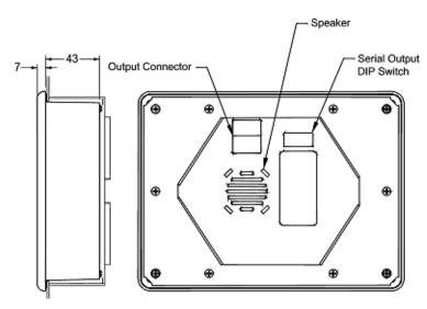
Figure 31 QTERM-Z60 Back Panel Mount
