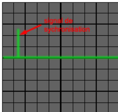
Les signaux vidéos sont des tensions de 0V à 0.7V, qui définissent l'intensité du point lumineux à l'endroit du balayage (cette tension est donc amenée à varier à chaque nouveau pixel de couleur différente ; pour un écran de résolution 800\*600 avec un rafraîchissement de 70Hz, les changements de tensions peuvent aller à une fréquence de  $800*600*70=34\text{Mhz}$ , soit 34 000 000 de fois par seconde).
