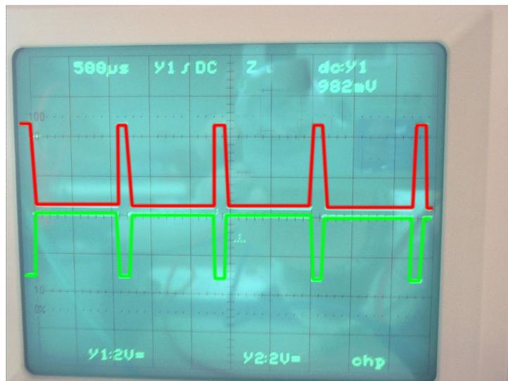
*Le signal original (et vert,  $-3\text{V}$ ) et après amplification (en rouge,  $+5\text{V}$ )*
