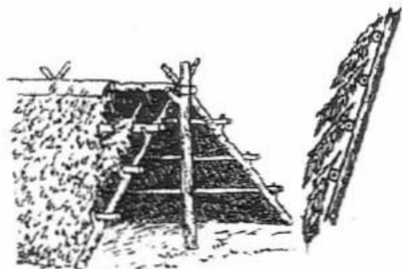
Bild 22 und 24. Zweighütte und Zweigdach
