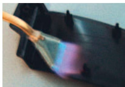
Beflammungs- test an einer geschäumten PU-Fläche
