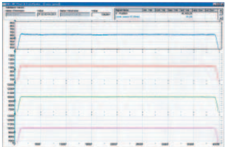
Bild 3: Bandgeschwindigkeit von vier in IMS C-Bügeln integrierten Polytec LSVs (in der 5-gerüstigen Tandemstraße von USS-Posco in Pittsburg, Kalifornien)
