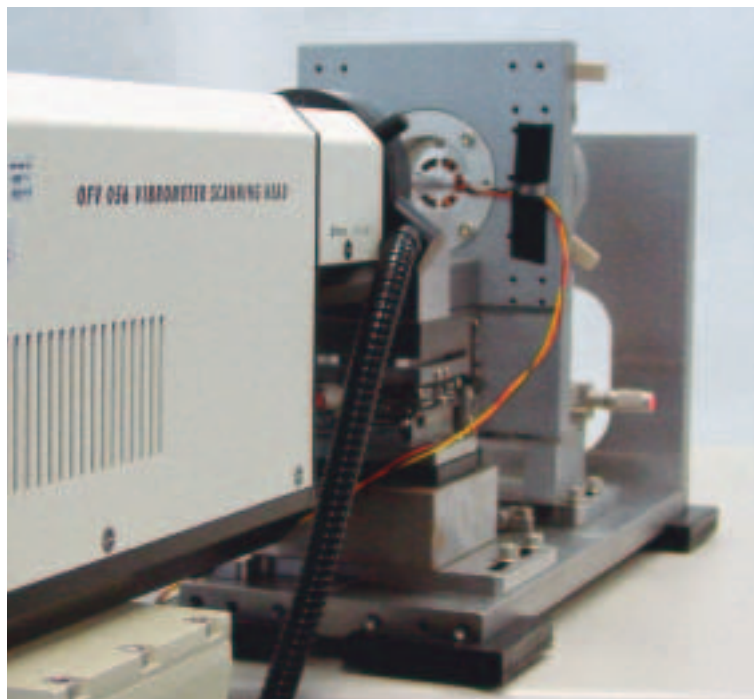
Bild 2: Messaufbau mit dem PSV Polytec Scanning Vibrometer und Close-up Unit
