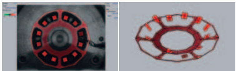
Bild 3: Darstellung der Scanning Vibrometrie-Messergebnisse für den Stator
