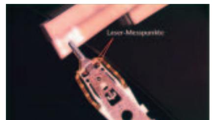
Bild 1: Schreib-/Lesekopf mit Messpunkten für den Laserstrahl
