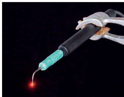
Bild 2: Der Laser des Scanning Vibrometers vermisst die Oberfläche eines zahnmedizinischen Ultraschallscalers
