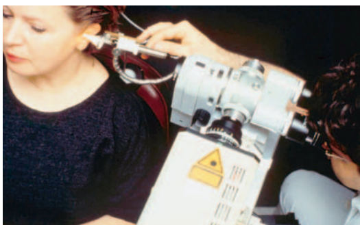
Laser-Audiometer zur schnellen Gehördiagnostik innerhalb weniger Sekunden
