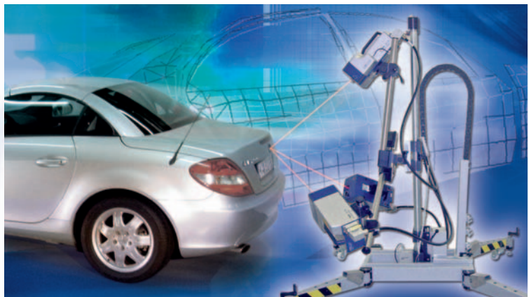
3D-Scanning-Messung der Strukturodynamik einer Autokarosserie
