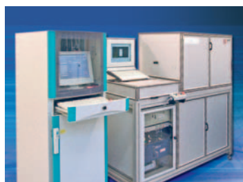
Bild 3: EVA (Einpunkt-Vibrometer-Automation) für 100 %-Qualitätskontrolle
