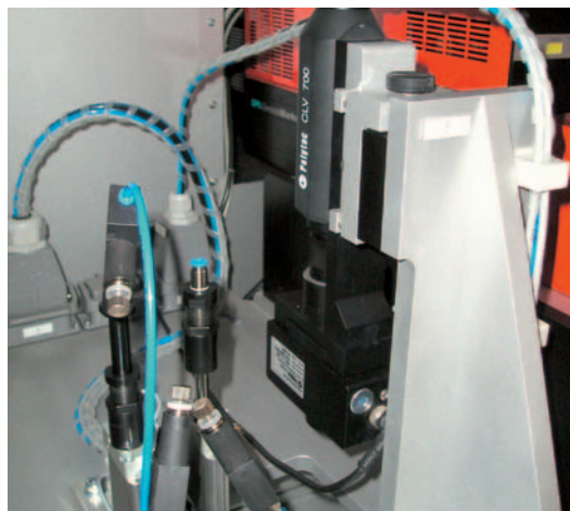
Bild 5: Integration des Compact Laser Vibrometer im Prüfstand mit vorgeschalteter Laserablenkeinheit
