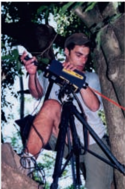
PDV-100 con maleta de transporte PSV-BS Expedición científica utilizando el PDV-100 para mediciones de vibración en abejas en la jungla en Sur América (Foto crédito: Jarau/ Hrncir, Instituto de Zoología, Dept. de Neurobiología, Universidad de Vienna, Austria)
