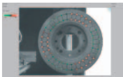
Bild 1: Darstellung der Scanpunkte auf einer Bremsscheibe
