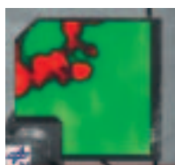
Bild 2: Delamination in einer C-C/ SiC-Keramik: 2. Harmonische (Anregung bei 20 kHz)
