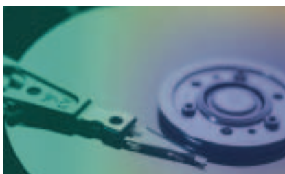
Bild 1: Tragarm mit Schreib-/Lesekopf einer Festplatte
