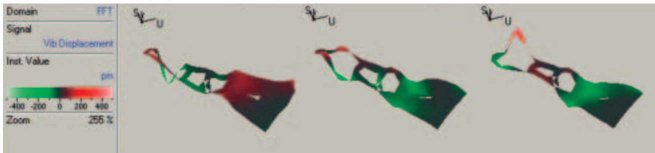
Fig. 2: PSV Scanning Vibrometer-Messungen auf dem Tragarm
