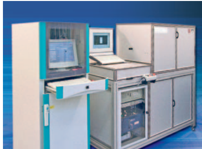
Bild 3: EVA (Einpunkt-Vibrometer-Automation) für 100 %-Qualitätskontrolle
