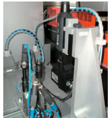
Bild 5: Integration des Compact Laser Vibrometer im Prüfstand mit vorgeschalteter Laserablenkeinheit
