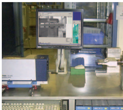
Bild 3: Messaufbau zur Charakterisierung der Sonotroden
