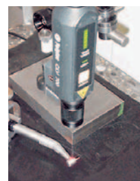
Schwingungsmessung an Zahnarzt-Bohrer (Foto: Myonic)
