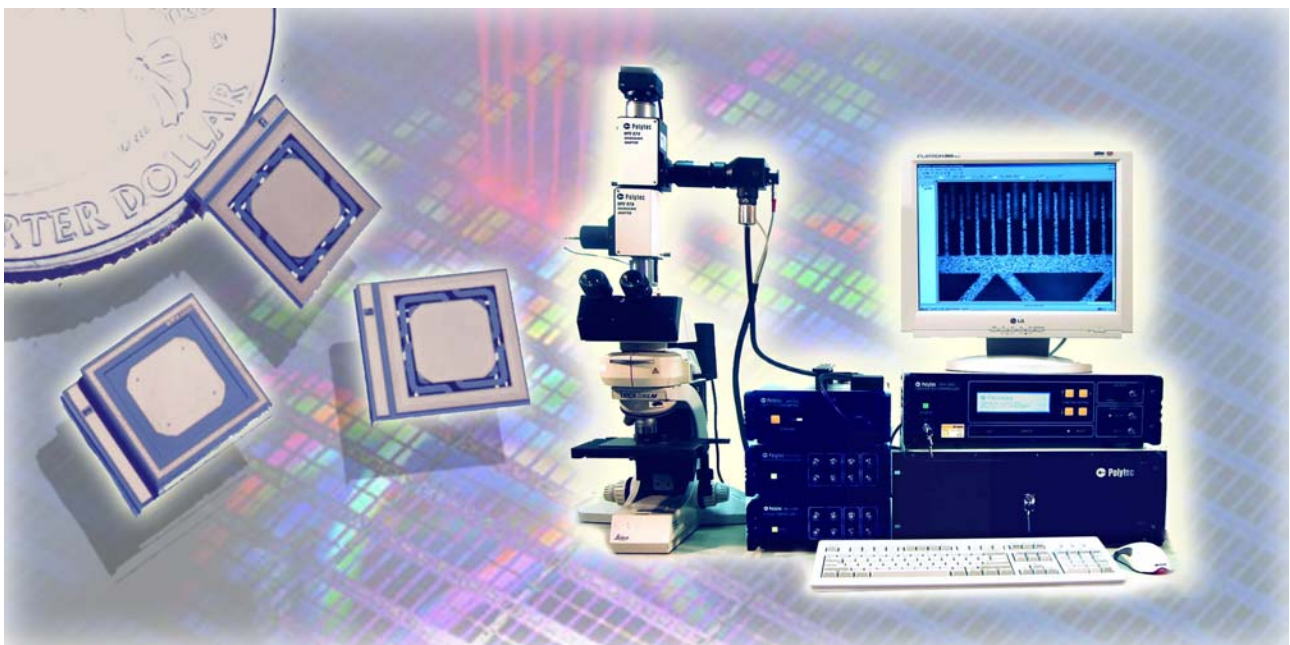
Abbildung 1: Polytec Micro Motion Analyzer MMA-300, Gesamtsystem
