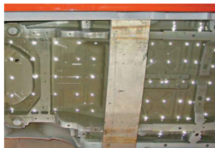
Bild 2: Messpunkte am Unterboden
