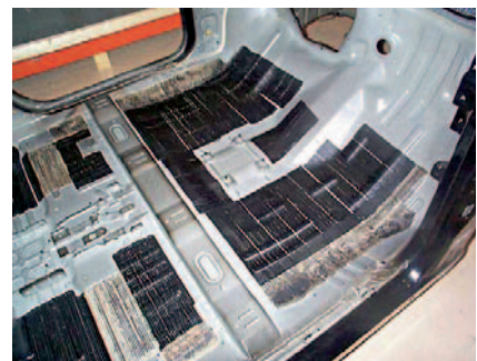
Bild 4: Bodenblech mit optimierter Verteilung des Dämmmaterials
