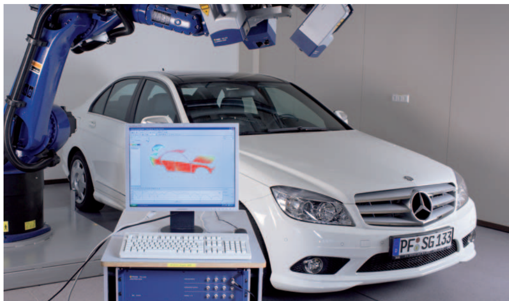
Bild 3: Messaufbau mit Scanköpfen auf Roboter, Fahrzeug und Messrechner
