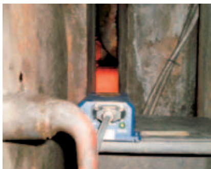
Bild 2: Polytec LSV Messkopf in Aktion
