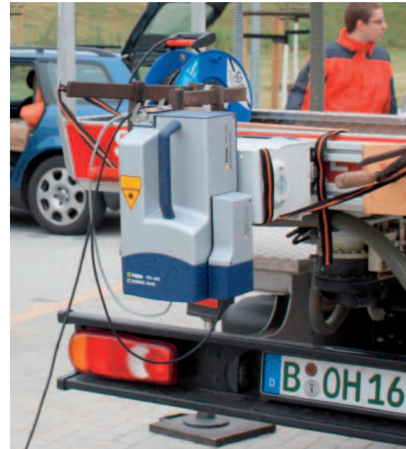
Bild 3: Messkopf des Vibrometers an der Plattform eines Hubsteigers
