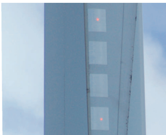
Bild 1: Laserpunkte auf den Reflexfolien am Rotorblatt
